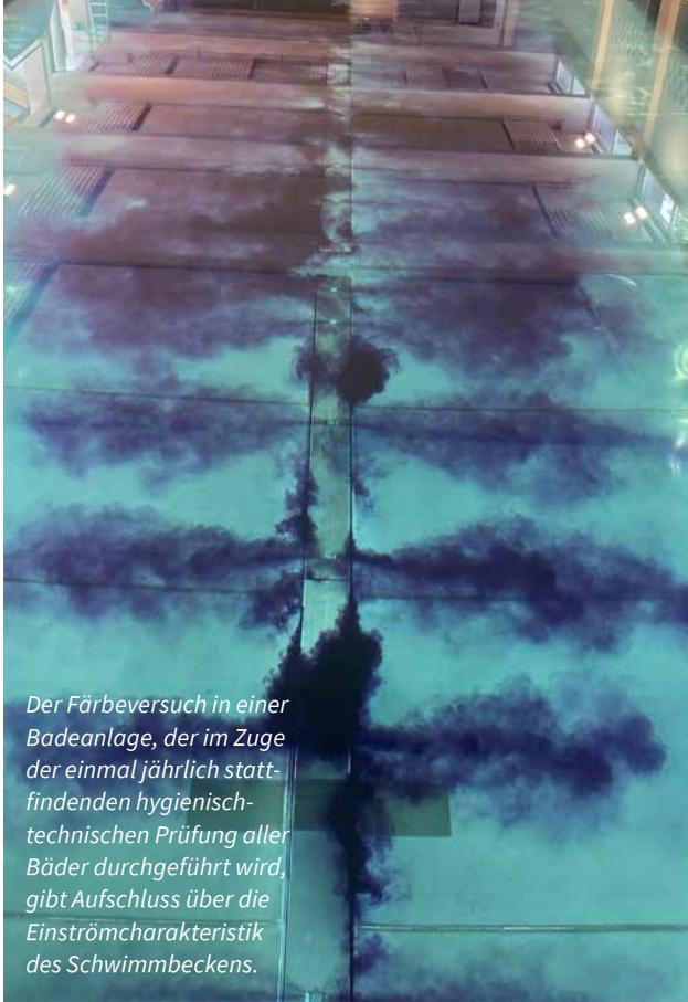
*Der Färbeversuch in einer Badeanlage, der im Zuge der einmal jährlich stattfindenden hygienisch-technischen Prüfung aller Bäder durchgeführt wird, gibt Aufschluss über die Einströmcharakteristik des Schwimmbeckens.*
