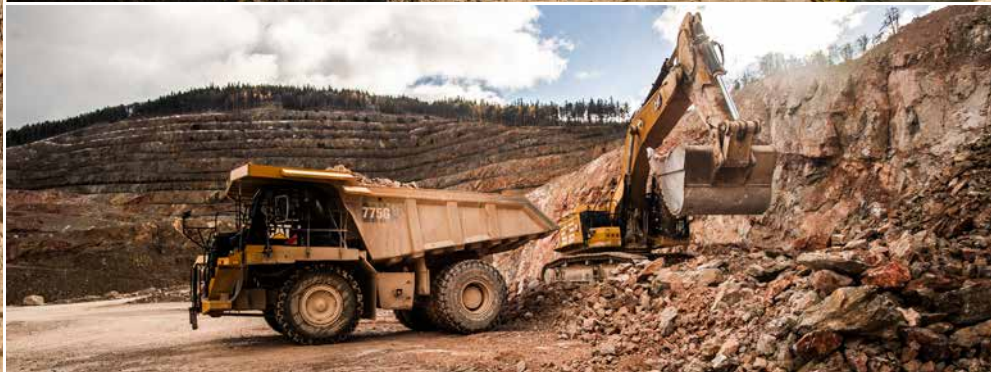
Arbeit in großen Dimensionen: Mit Bohrgerät, leistungsstarkem Hydraulikbagger und 65-Tonnen-Muldenkippern wird auf den Etagen Kalkstein gewonnen.
