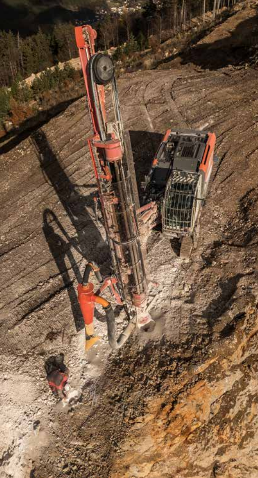
Arbeit in großen Dimensionen: Mit Bohrgerät, leistungsstarkem Hydraulikbagger und 65-Tonnen-Muldenkippern wird auf den Etagen Kalkstein gewonnen.
